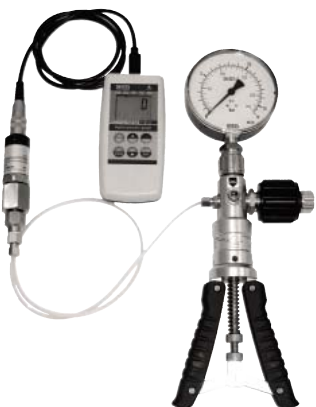
Kalibreringsinstrument för tryck Handinstrument CPH 6200, tryckgivare CPT 6200 och handpump CPP 30. Komplett med väska och inredning.
