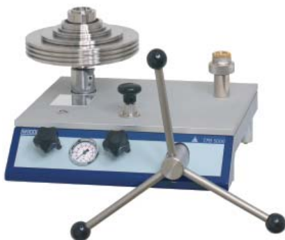
Kalibreringsvåg Precisionsvågmed vikter. Tryckområde 0-100 bar eller 0-4000 bar
