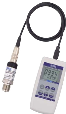
Serviceinstrument tryck CPH 6200 standard Handinstrument med display Uttag för en tryckgivare Utgång RS232 eller USB Tryckgivare CPT 6200 Tryckområde till max 0-1000 bar
