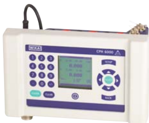
Processkalibrator för tryck CPH 6000 precision med integrerad tryckgivare CPT 6000 med mätnoggrannhet kl. 0,0025%
