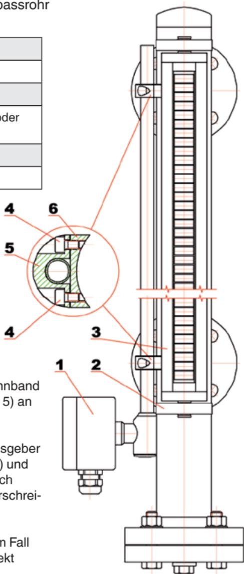
Messwertgeber MG ... mit Spannband oder Befestigungsschelle (Pos. 5) an das Bypassrohr anbringen.
