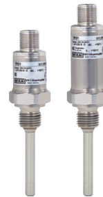
Tempgivare TR31 1 x Pt-100 kl B, 3-ledare. Område -50+150°C eller -50+250°C med hals 70 mm. Införing 25-200 mm.
