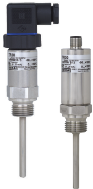
Tempgivare TR30 1 x Pt-100 kl B, 3-ledare. Område -50+150°C eller -50+250°C med hals 70 mm. Införing 50, 100 eller 150 x 6 mm.
