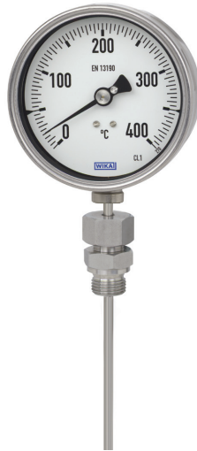
Standardutförande 2 Skjutbar förskruvning direktmontering eller för montering i skyddsicka G1/2", 1/2"NPT eller M18x1,5
