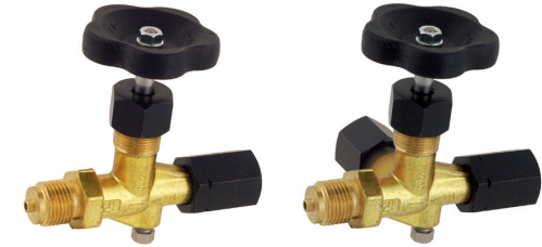
Nålventil enligt DIN Standard eller med kontrolltapp Inlopp med utvändig anslutning Utlopp med anslutningsstycke Mässing, stål eller syrafast stål Anslutning G1/2"
